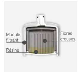
Filtre robinet BIOFIL en coupe
