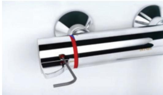
Déblocage de la butée de température pour réaliser un choc thermique : enfoncer simplement le bouton rouge avec un outil pointu.
