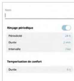
Cette fonction « copier-coller » permet d'enregistrer les réglages choisis sur l'application et de les dupliquer sur d'autres robinetteries. Un gain de temps assuré lors de l'installation.
